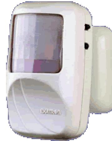
O Sensor de Presença Frontal é um comando inteligente que se destina ao acionamento de carga temporizadas. Detecta a movimentação de fontes de calor como pessoas e carros, através de um sensor infravermelho, acionando a carga e desligando -a após a ausência, de acordo com o tempo programado.
