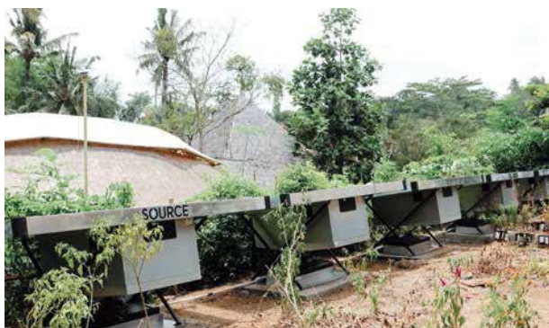
図表3 インドネシア、バリ島のグリーンスクールに設置されたZero Mass Waterのハイドロパネル （写真提供：Kopernik）
